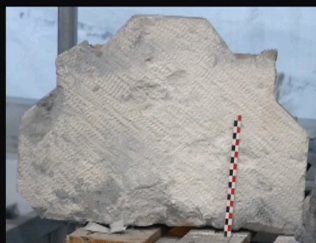
Trois bretures différentes, avec des dents de 3, 4 et 5 mm Taille oblique, en gerbe, chevron, croisée, désordonnée
