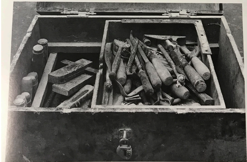
Caisse à outils de tailleur de pierre, Photographie An My Lê, Source : Encyclopédie des Métiers, La maçonnerie et la taille de pierre , Paris, 2007, Librairie du Compagnonnage, Tome 5
