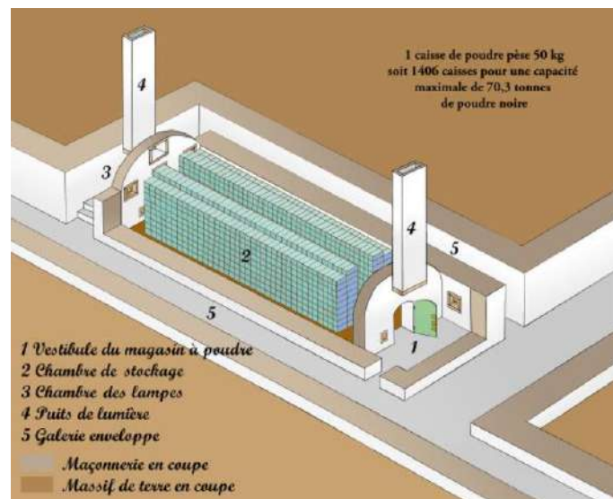
Fig 55: Axonométrie d'une poudrière type Séré
